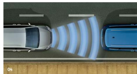
04 预碰撞安全系统, 当与前车距离过近时发出警报, 并启动辅助制动, 降低碰撞伤害, 避免碰撞。
