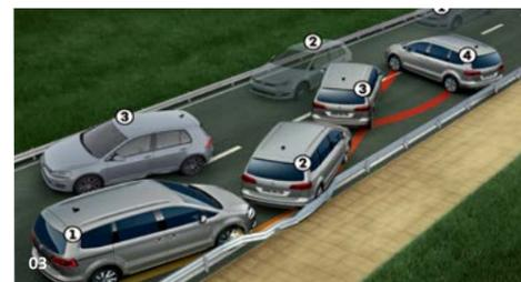
03 多次碰撞预防系统, 将在系统极限范围内自动对车辆进行制动, 以避免或减弱后续碰撞发生的风险。
